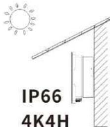
5. Die Montagebedingungen müssen für das Gewicht und die Größe des Wechselrichters geeignet sein. Der Wechselrichter eignet sich zur Montage an einer festen Wand, die vertikal oder nach hinten geneigt ist (max. 15°). Es wird nicht empfohlen, den Wechselrichter an Wänden aus Gipskarton oder ähnlichen Materialien zu installieren. Der Wechselrichter kann bei der Arbeit Geräusche verursachen.
