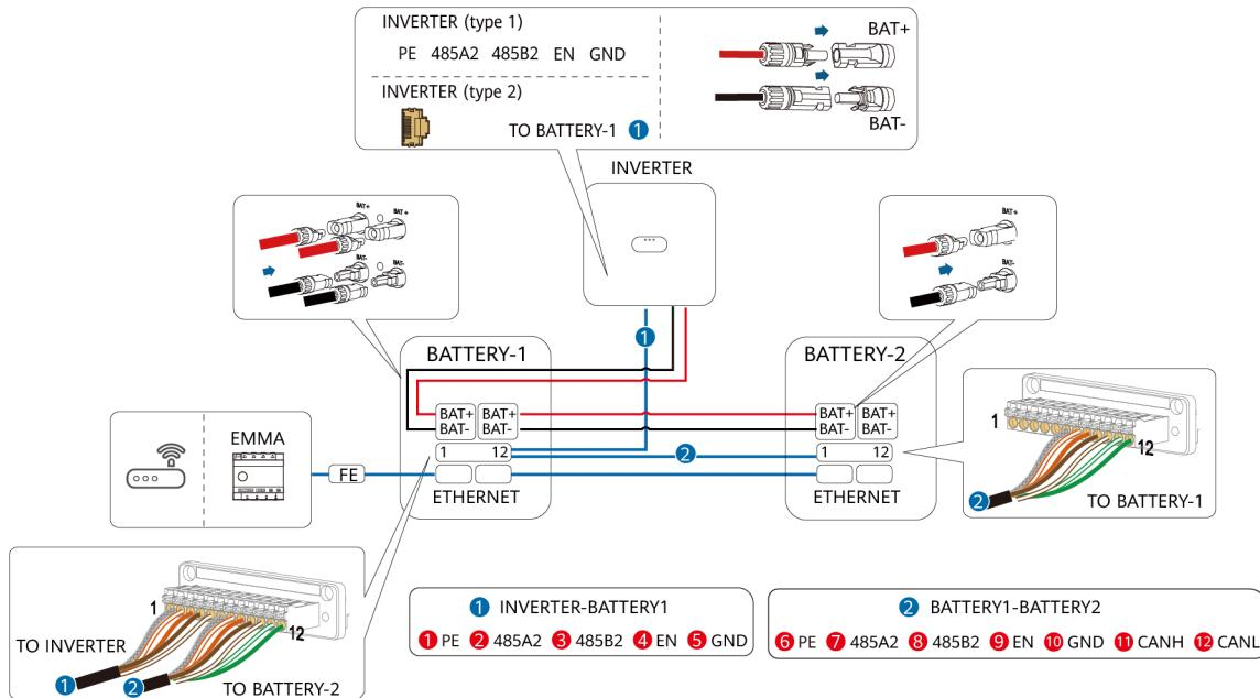
**BG** За подробности относно свързването на паралелни кабели вижте ръководството за потребителя.
