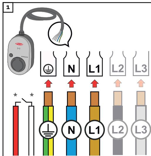
Das 5-polige Netzkabel entsprechend der nationalen Normen und Sicherheitsvorschriften von einem konzessionierten Elektroinstallateur anschließen lassen. Je nach verfügbarer Netzform 1- oder 3-phasig anschließen.
