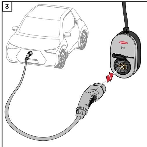
Ein Typ 2 auf Typ 2/Typ 1 Ladekabel mit dem Wattpilot und dem Fahrzeug verbinden.
