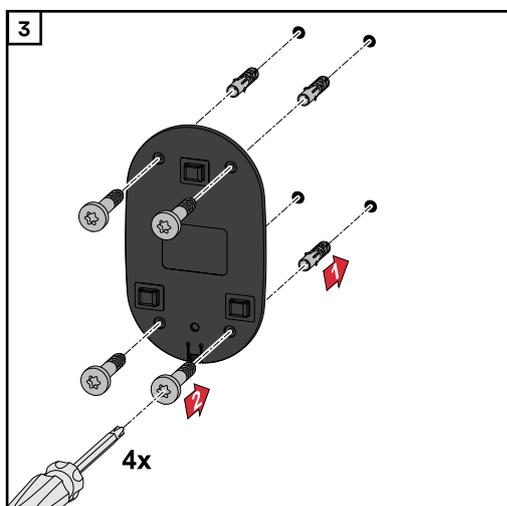
Dübel in die Bohrungen geben und die Montagehalterung mit Schrauben befestigen.
