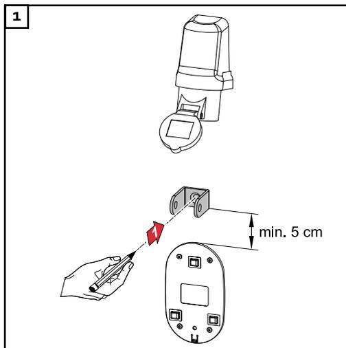
Den Diebstahlschutz mindestens 5 cm über der Montagehalterung montieren.
