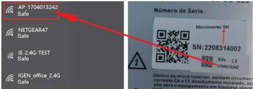
Mikrowechselrichter-SN: 2208314002; Eingebauter Datenlogger: 1704013242
